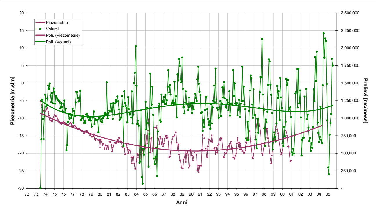
Serie storica dei prelievi e delle piezometrie al centro di San Vitale
